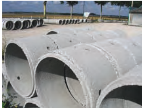
Buse perforée utilisée pour concevoir des puits d'infiltration
